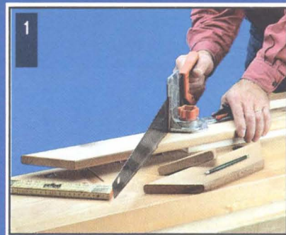
1 Доски раскраивают на заготовки заданных размеров (см. чертеж).
